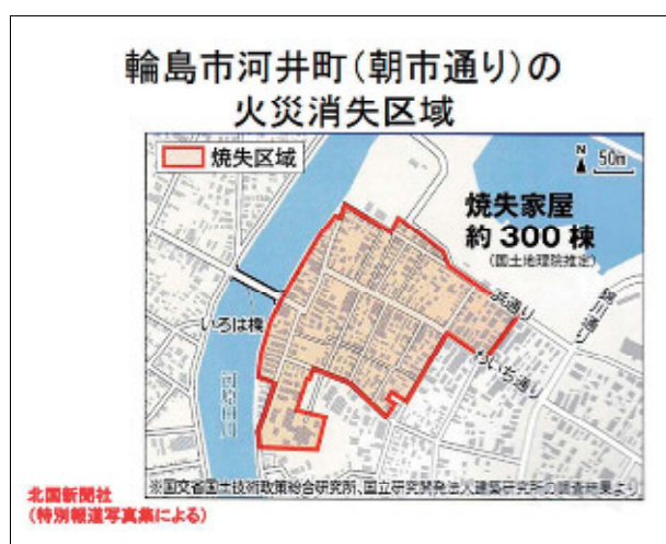
図-41 輪島市に発生した延焼火災による消失区域
